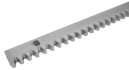
CRIS200 - Art.Nr. 162322 Zahnstange M4 aus verzinktem Stahl mit Schrauben und Distanzstücken 30x12x1000 mm (10Stck/Packung)
