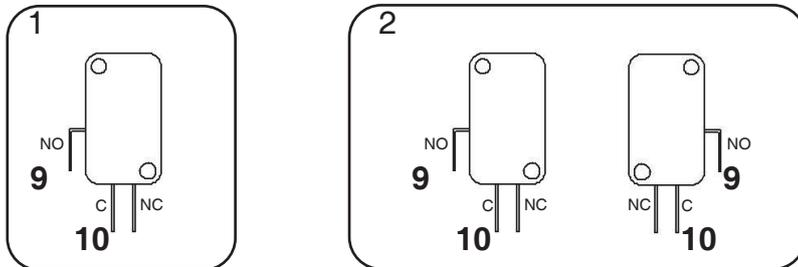
ⓘ Sollen mehrere Bedienelemente angeschlossen werden, so werden die Schliessekontakte parallel zueinander angeschlossen (Bild 2).
