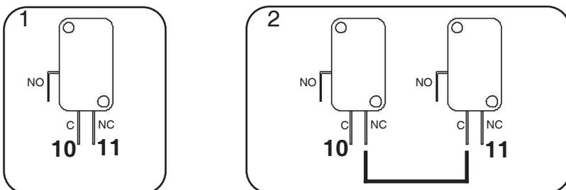
ⓘ Beachten Sie, dass bei Verwendung mehrerer Elemente auf STOP alle potentialfreien Öffnerkontakte in Reihe geschaltet werden müssen! (siehe Bild 2).
