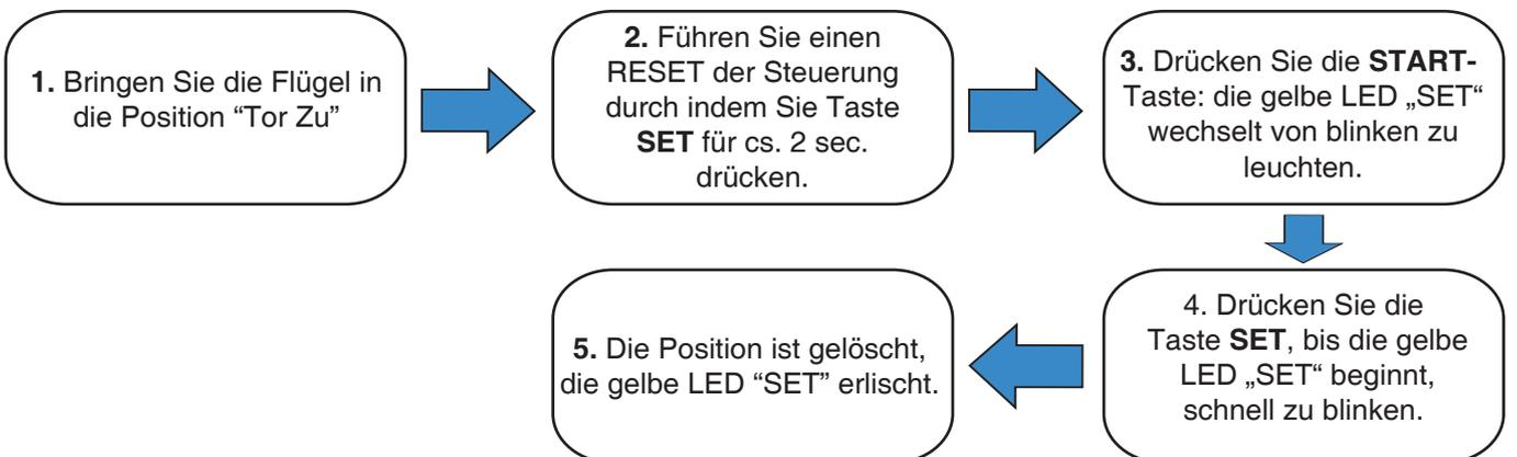
Nach der Löschung kann über ggf. an Klemme 15 angeschlossene kabelgebundene Bedienelemente nur noch eine vollständige Öffnung realisiert werden; Bedienung über Handsender ist nicht mehr möglich.
